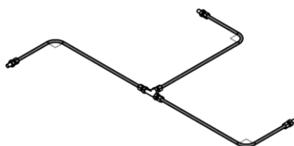
Trecho de instrumentação "T" ( L1=L2=L3=L4=L5=L6=25,4 mm, L_{TOTAL}= 152,4 m)
