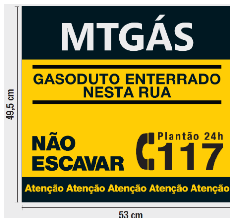
Detalhe Típico Placa PVC/Adesivo
